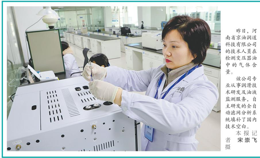
昨日,河南省京油润道科技有限公司的技术人员在检测变压器油中的气体含量。该公司专业从事润滑油技术研发及油液监测服务,自主研发的全自动滤网分析系统填补了国内技术空白。本报记者 宋崇飞 摄
